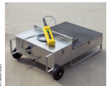
Simulation unterschiedlicher Brände mit der Dräger Brandwanne
